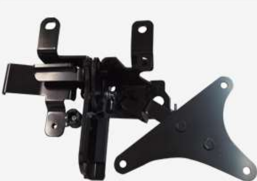
名称：バンパーステップ 材質：高張力鋼 用途：トラック用部品 板厚：1.6t/2.3t/4.5t/6.0t
